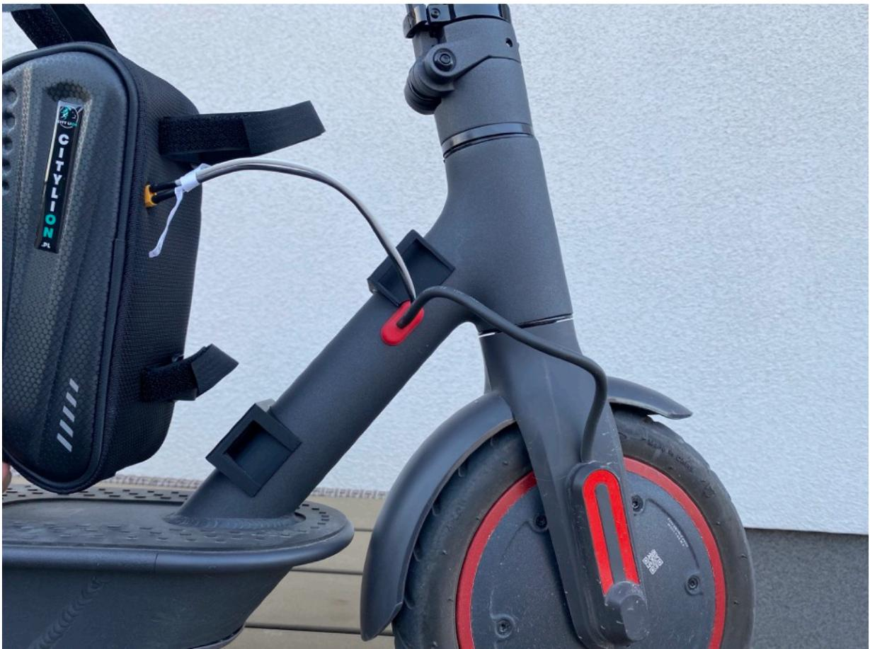
**9.** Montez le sac sur le pont du scooter à l'aide des supports en plastique fournis.
