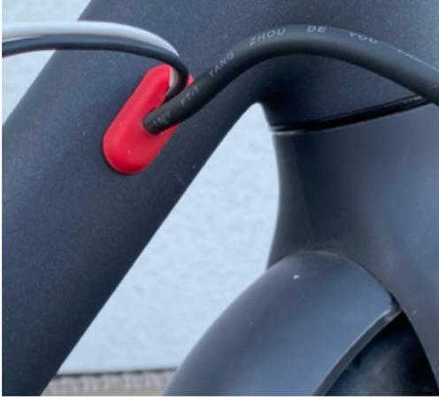
2. Retirez le passe-fil en caoutchouc du scooter (celui avec un seul fil, sur le côté droit).
