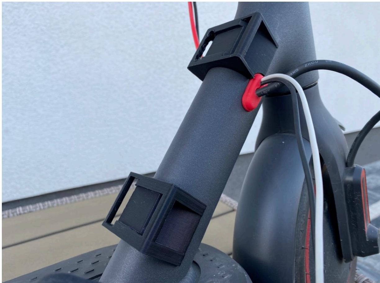
**10.** Insérez la boucle du sac en plastique dans le trou du support. Enfilez le Velcro dans la boucle et serrez.
