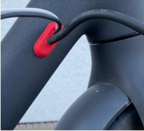
2. Retire el ojal de goma del scooter (el que tiene un solo cable, en el lado derecho).
